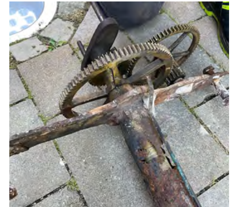
Rost hatte den Zeigerwellen auf der Westseite des Turms zugesetzt, so dass die Mechanik klemmte
