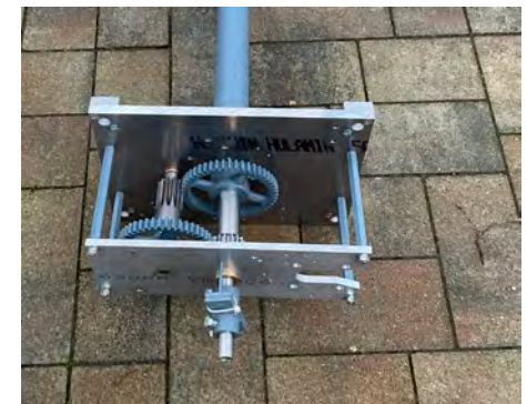
Das defekte Stulperrohr und die defekten Minuten- und Stundenzeigerwellen mussten neu angefertigt werden
